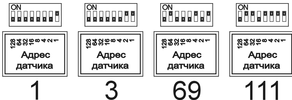
Рис.12.2. Примеры установки различных Modbus адресов.
