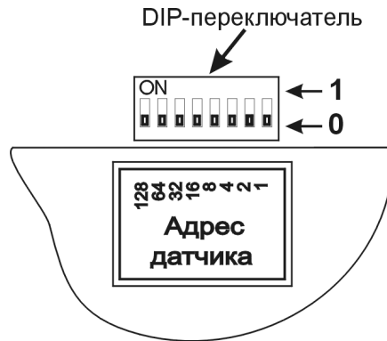
Рис.12.1. Переключатель Modbus адреса в положении все нули.
